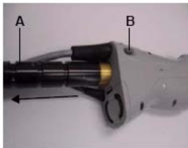
Рисунок D-20 демонтаж скользящего контакта из излучателя
