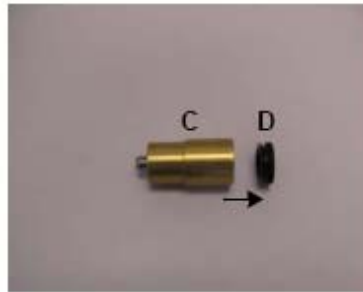
Рисунок D-12 демонтаж фиксатора окошка из скользящего соединения
