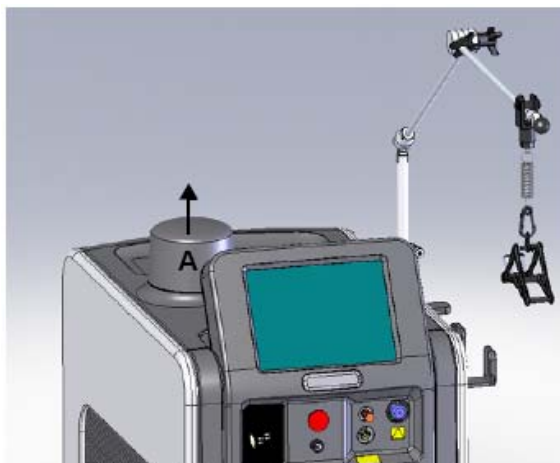
Рисунок D-22 демонтаж крышки ДСД
