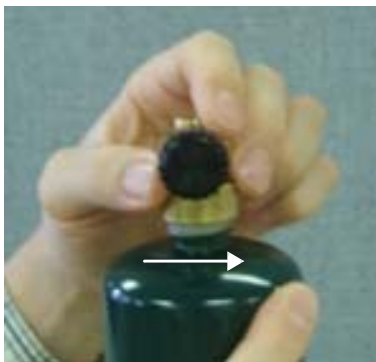
Рисунок D-26 установка выпускного клапана на контейнер
