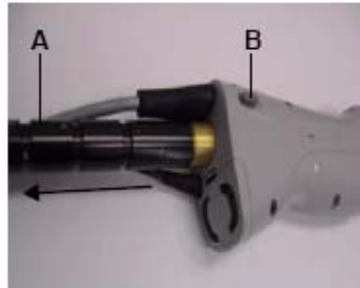
Рисунок В-5 демонтаж скользящего контакта из излучателя
