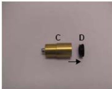
Рисунок В-7 демонтаж фиксатора окошка из скользящего соединения
