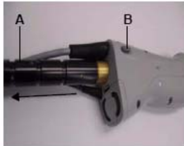
Рисунок D-10 демонтаж скользящего контакта из излучателя
