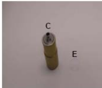
Рисунок D-13 демонтаж окошка из скользящего соединения
