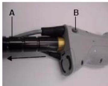
Рисунок D-18 демонтаж скользящего контакта из излучателя
