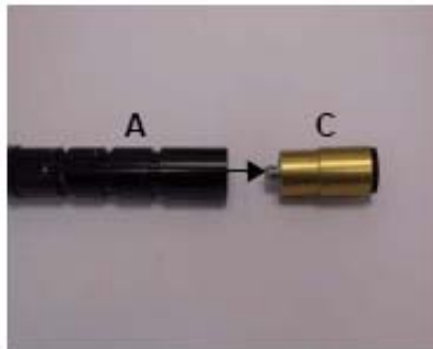
Рисунок В-4 демонтаж скользящего соединения из скользящего контакта
